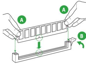
So entfernen Sie ein DIMM
